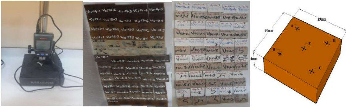
Şekil 2. Kalınlık artış oranının belirlenmesinde kullanılan deney numunesinin şekil ve boyutları ile numunelerin ölçmesinde kullanılan komparatör saati.
