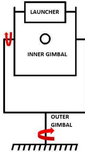
Şekil 1 AKS Gimbal Şematik Gösterimi
