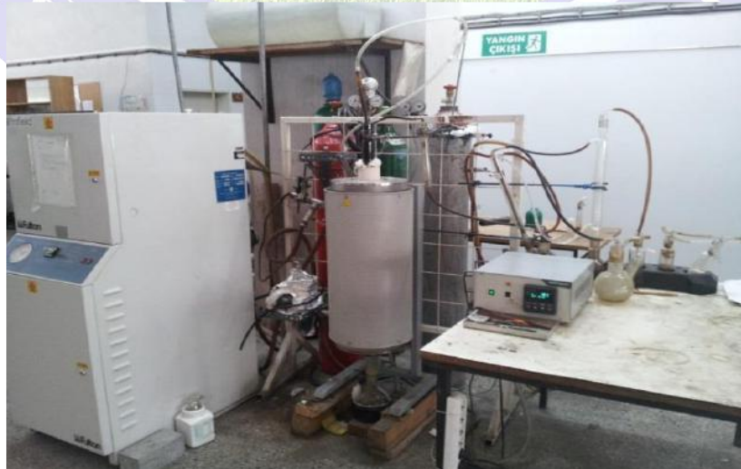
Şekil 1 Pirinanın Karbon Dioksit Ortamında Gazlaştırılması – Deney Düzenegi
